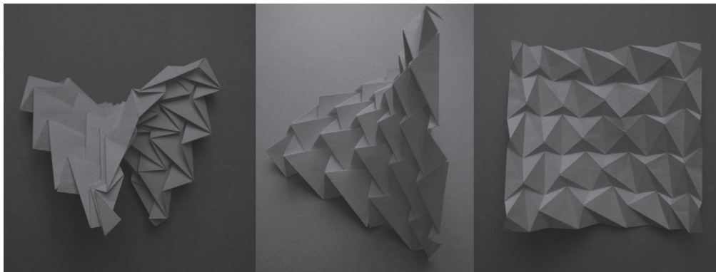
図 7: 実際に紙で折ったバリエーションモデル。左: 平坦折り状態, 中: 三次元状態, 右: 展開状態
